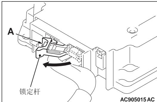
推动线束侧插接器图中标记“A”的部分时, 将锁止杆转到箭头的位置以松开锁止杆。
